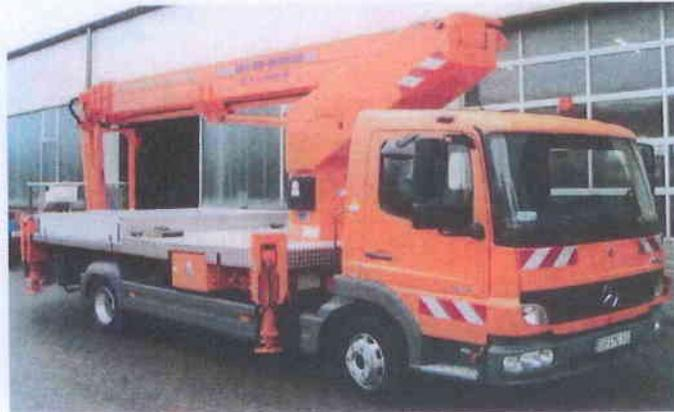
Diese Teleskop Arbeitsbühne vom Typ Ruthmann TK 310, mit einer Arbeitshöhe von 31 Metern auf ein MB Atego Fahrgestell aufgebaut. Der drehbare Aluminium Arbeitskorb ist mit einer Start- und Stop Anlage für den Fahrzeugmotor und einer 230 Volt Anschlussleitung im Korb ausgestattet.
