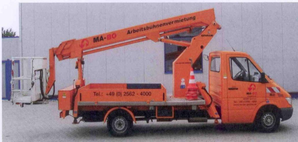
Diese Teleskop Arbeitsbühne vom Type TL 165 mit 16,3 Metern Arbeitshöhe ist auf einen Mercedes Benz montiert. Im Aluminium Arbeitskorb ist eine 230 Volt Arbeitssteckdose montiert. Große Wendigkeit und große seitliche Reichweite bei sind die Besonderheiten dieser Arbeitsbühne. Die Vermietung erfolgt an Selbstfahrer.
