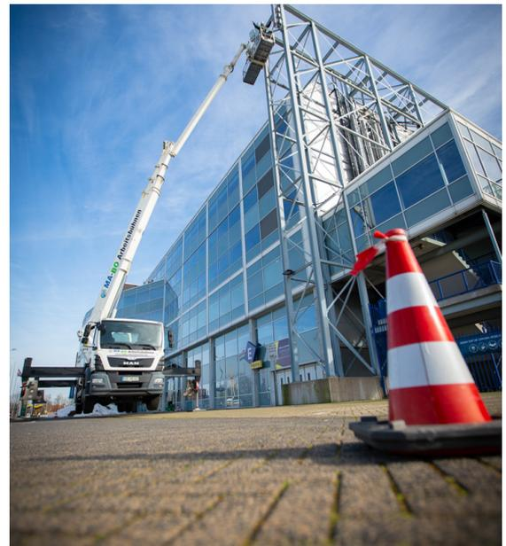
Für Outdoor-Einsätze wie z.B. einem Dachstandort, einem Turm oder einer Kirche, werden LKW-Arbeitsbühne zwischen 30 m und 75 m und manchmal sogar 90 m Höhe verwendet. Grundsätzlich werden die LKW-Arbeitsbühnen immer mit einem Bediener vermietet.
